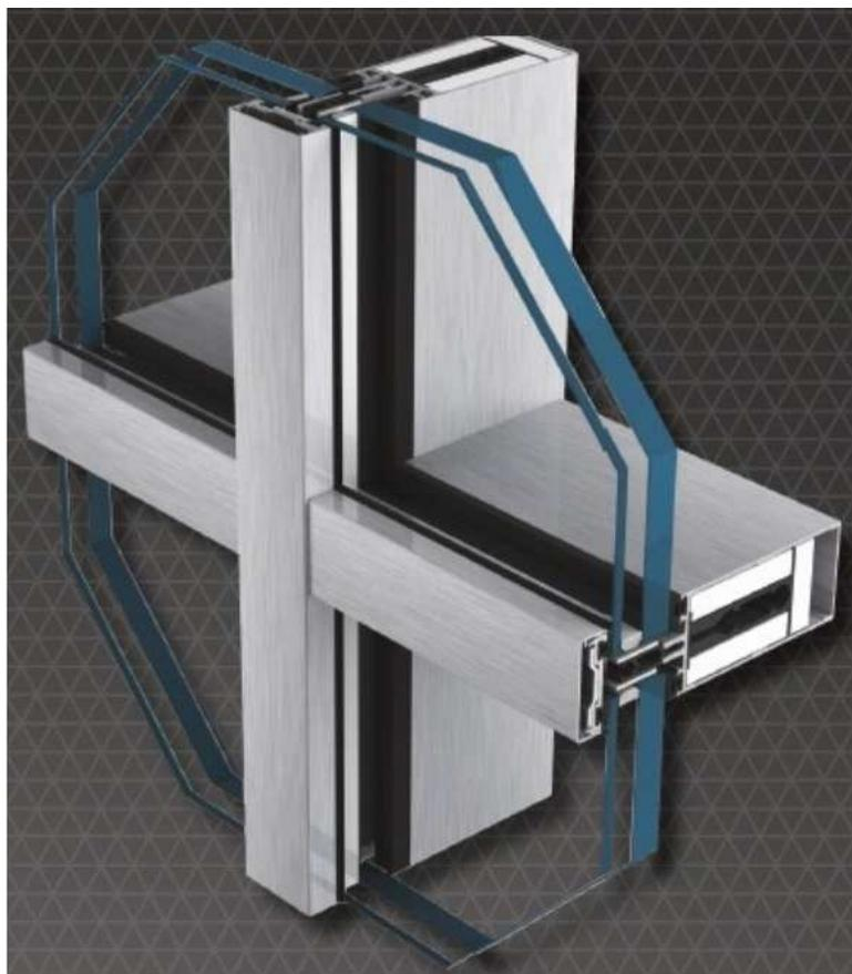
С целью достичь устойчивости огню, вертикальные профили и поперечные профили монтируются со специальными гипсовыми огнеустойчивыми вкладками. Вкладка повторяет форму алюминиевой секции и функционирует как жароизолятор.
